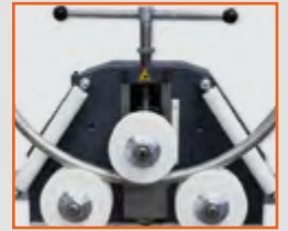
Paslanmaz Malzeme Kıvrımına Özel Delrin Vals Topları Plastic Rolls For Stainless Steel Bending
